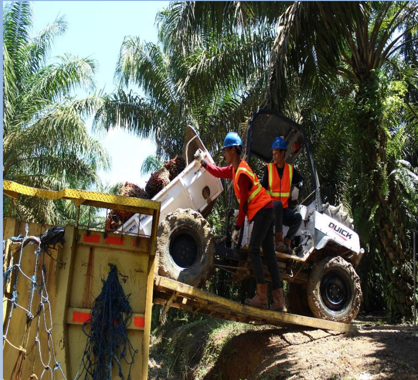
Gambar I – Pemuatan TBS ke BIN dari Truk mini QUICK secara hidrolis
